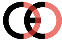
Falsche CE-Kennzeichnung (zu dicht)
